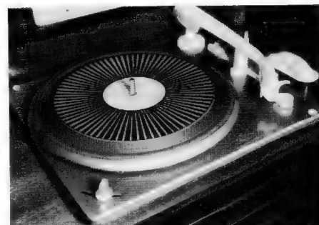
Bild 2. Drehzahlüberprüfung eines auf 78 Umdr./min. geschalteten Plattenspieler
