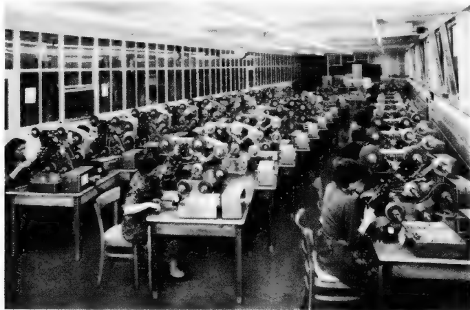
Kondensator-Wickelmaschinen in einem der hellen Säle des neuen Werkes der Fa. Westermann in Mannheim
