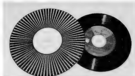
Bild 1. Stroboskopscheibe für 78 Umdr./min. neben einer handelsüblichen Schallplatte
